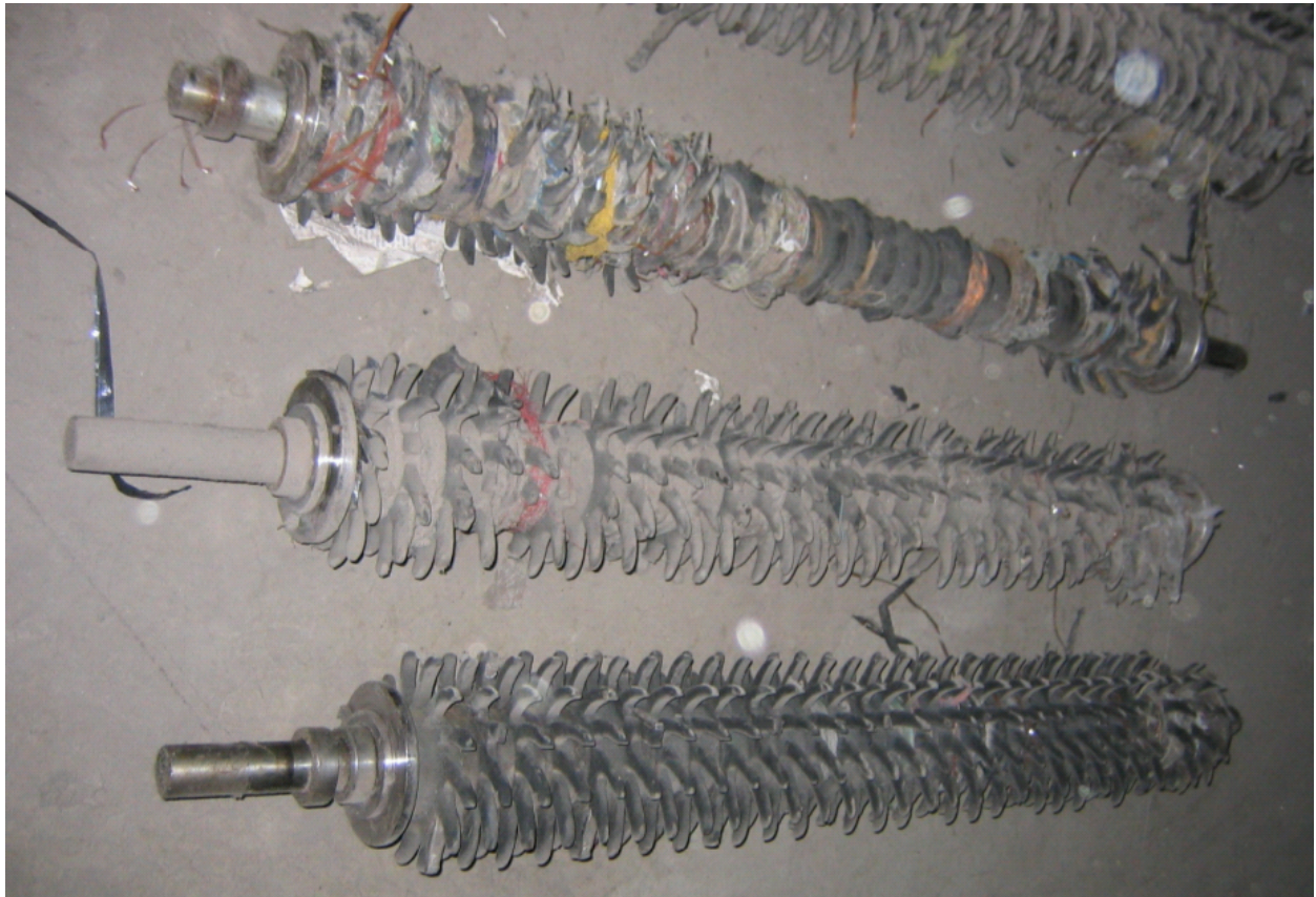
Abbildung 7: Wellen eines Sternsiefs, neu, benutzt, verschlissen (von unten nach oben)
