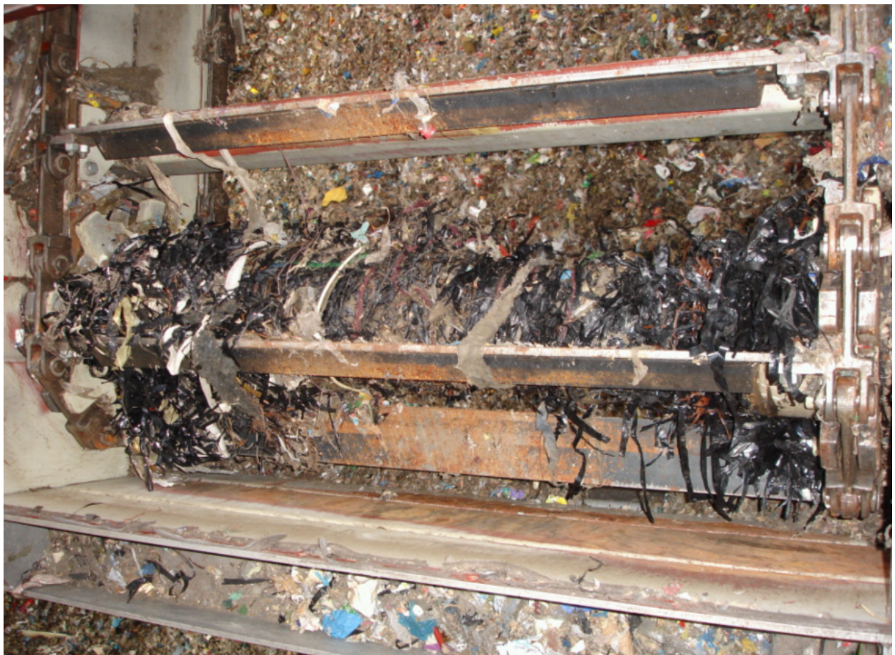
Abbildung 9: Umwicklungen der Umlenkrolle bei einem Trogkettenförderer
