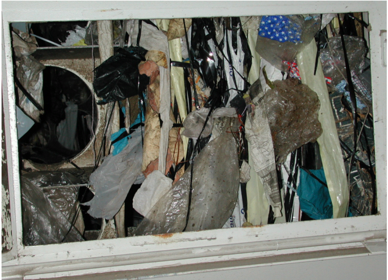
Abbildung 6: Siebtrommel, Lochung 250 mm, Einsatzzeit 6 h mit 20 Mg/h
