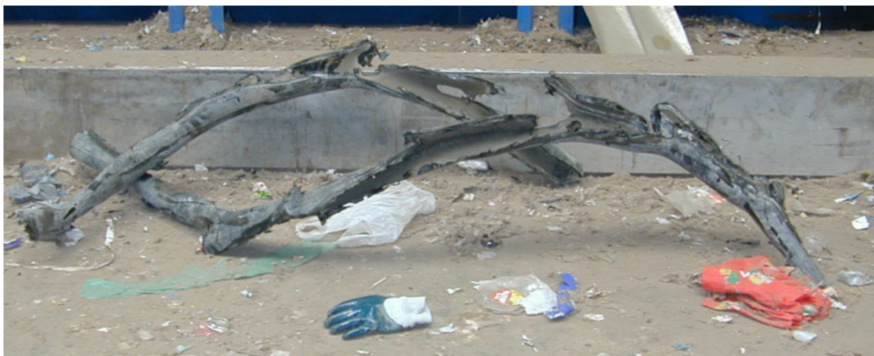
Abbildung 1: Nicht ausreichend zerkleinertes Kunststoffrohr, Zerkleinerer ohne Mittelkamm
