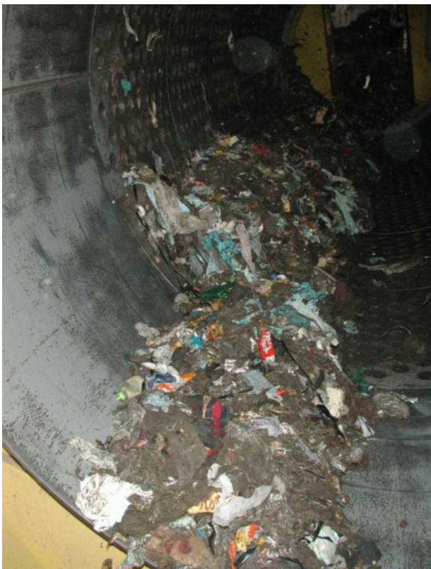
Abbildung 5: Fehlende Mitnehmer verhindern eine ausreichende Umwälzung des Materials
