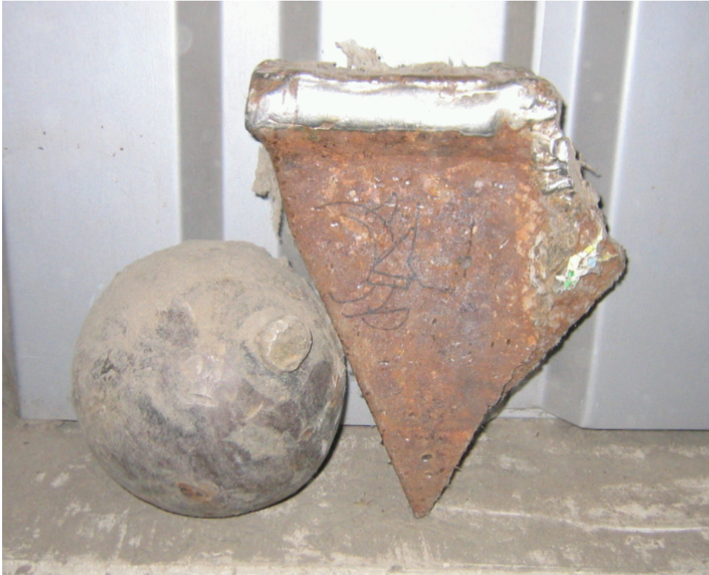
Abbildung 3: Störstoff und abgerissenes Gegenmesser
